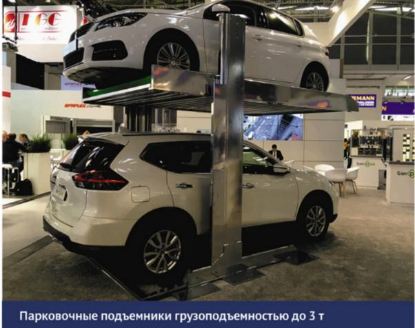
Парковочные подъемники грузоподъемностью до 3 т
